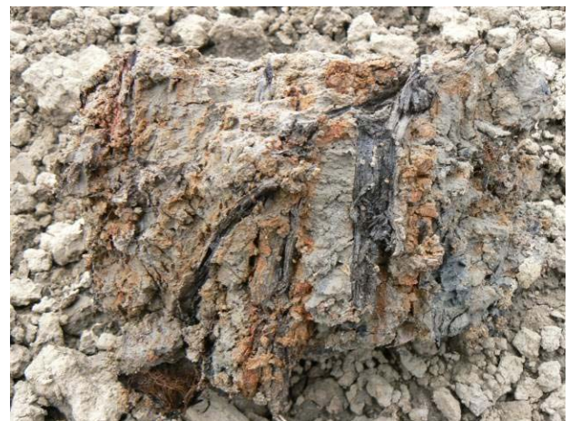
Abbildung 1: Tonreiches, organisches Sediment (hier: lagunäres Sediment mit schwarzen Wurzelresten und oxidativem Eisensaum).
