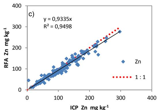
**Abbildung 3:** Gegenüberstellung der an Laborproben vorgenommenen Messungen mittels ICP (Abszisse) und RFA (Ordinate) für a) Kupfer, b) Blei und c) Zink.
