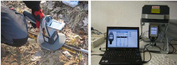
**Abbildung 2:** Feldmessung und Labormessung mit Probenkammer.
