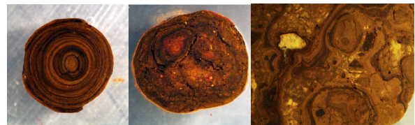
Abb.1: unterschiedliche Bohnerzformen im Anschliff (v.l.n.r.): Pisoid, Nodule, verkitteter Komplex
