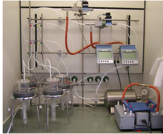
Abbildung 1: Versuchsaufbau des modifizierten Perkolationsystems. Eine Membran-Vakuumpumpe erzeugt Unterdruck, der durch zwei Vakuum-Controller angepasst wird. Luer ® -Leitungen kanalisieren sowohl Atmosphären- und Unterdruck an jedem der vier Perkolationsplätze. Eluate werden in Steriflip ® -Gefäßen aufgefangen, an denen der Unterdruck schrittweise von -30 auf -300hPa erhöht wird.
