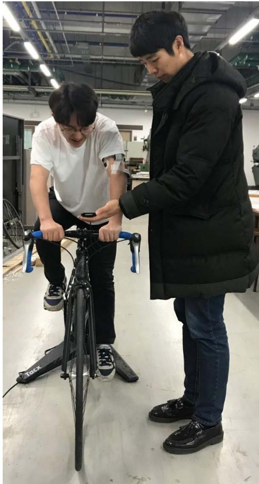
Figure 24. 싸이클 에르고미터를 이용한 심박수-일률 측정
