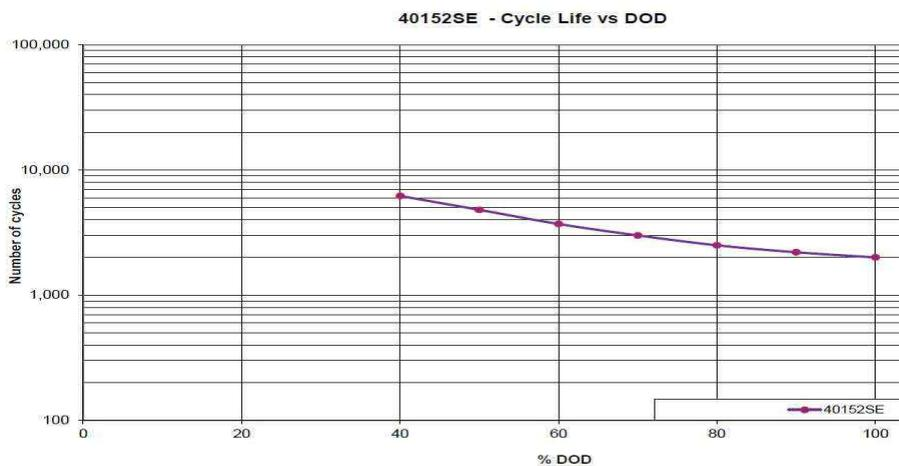
[그림 2] DOD 별 Cycle (리튬 이온전지)
