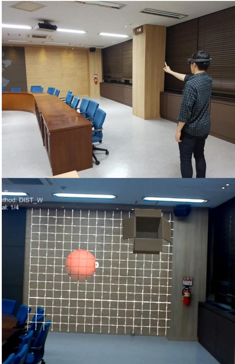
그림 5. 예비 사용자 실험 환경. 참여자들은 지름 0.25m의 빨간색 구를 열려 있는 상자에 넣는 태스크를 진행했다. 벽은 참여자로부터 10m 떨어져 있으며, 공간을 조작하는 데에 사용되는 가상의 벽은 격자 무늬 형태로 렌더링되었다.
