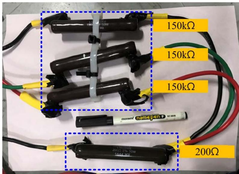
그림 6.15. 실험에 사용된 SPR 모의 접지 시스템.
