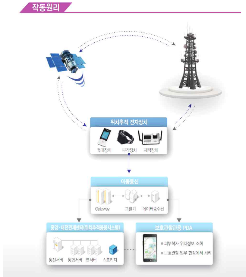
〈그림1〉 위치추적 전자장치의 작동원리
