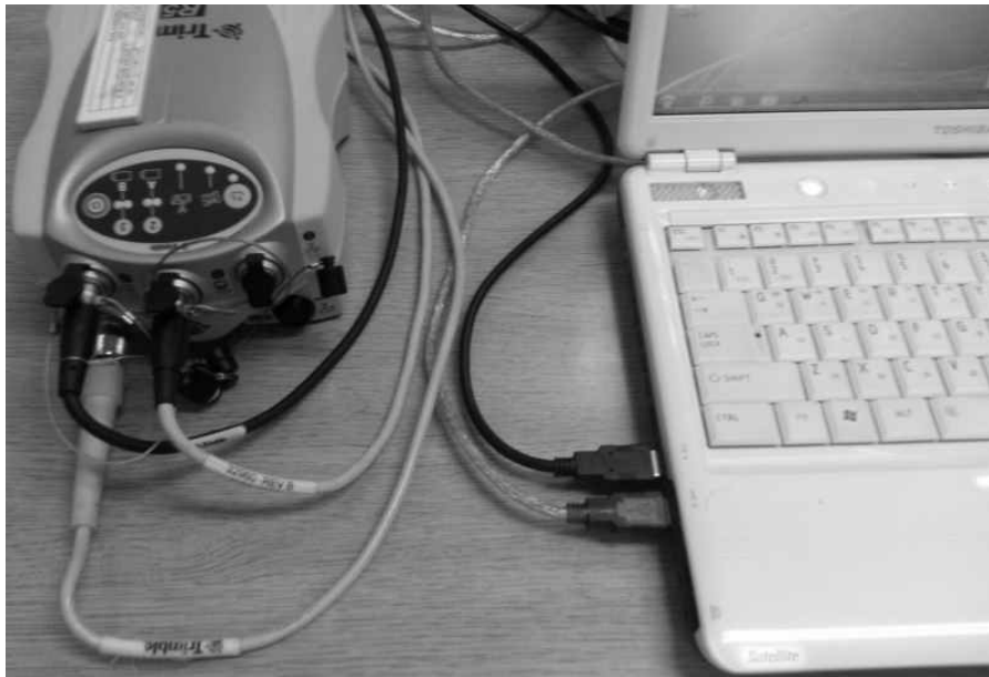
[그림 3-5] RTK-DGPS 수신기와 제어기 역할을 하는 노트북
