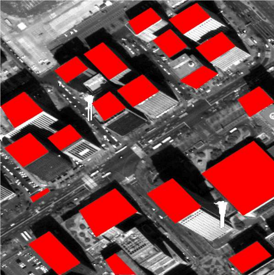
[그림 4-12] QuickBird-2 영상의 건물 상단 추출 결과
