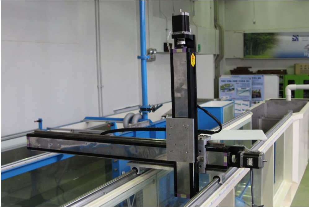
그림 3.14 Auto traverse를 이용한 자동이송장치
