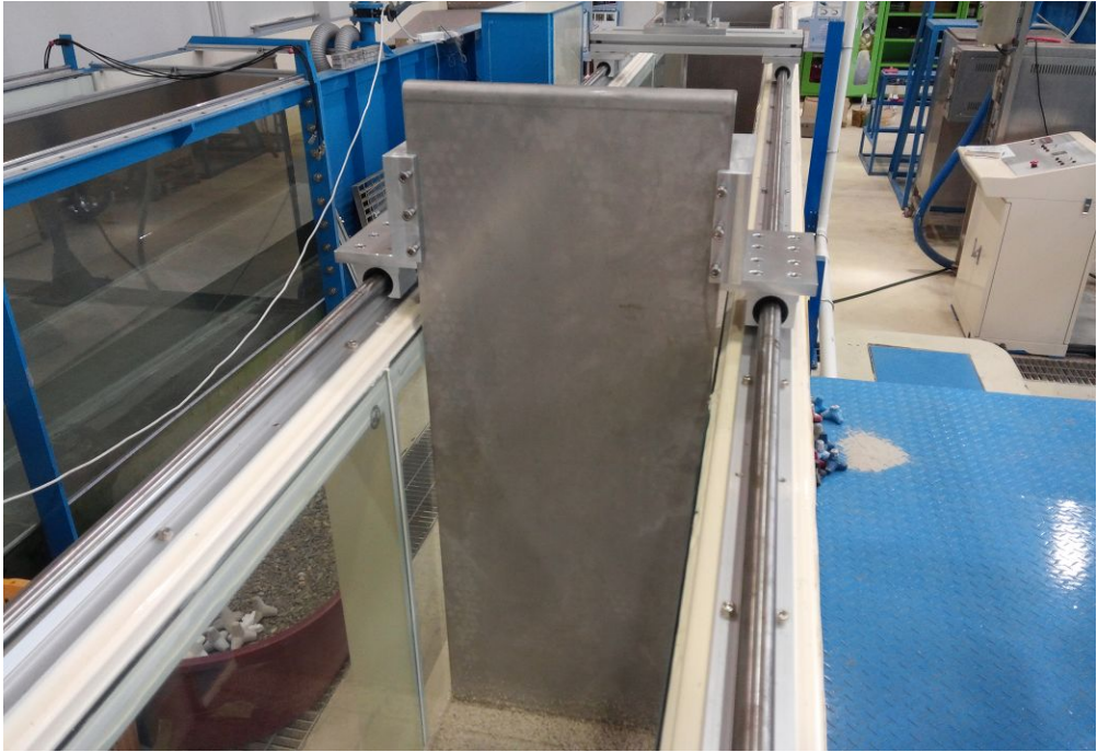
그림 3.16 유사 설치를 위한 하상 평탄화 장치
