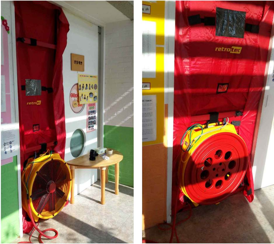
[그림 4.1] 대상 보육실의 Blow door test
