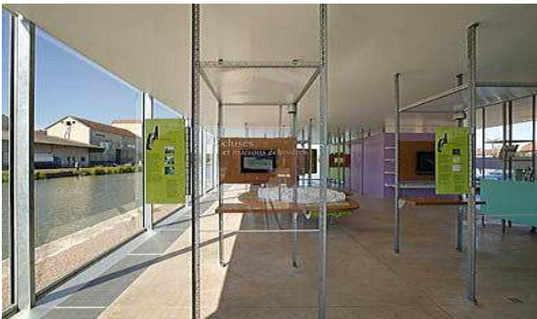
그림 21 Institute, Centre D'Interpretation du Canal de Bourgogne, 2005. 본 프로젝트에서 시계루 반은 선반의 구조를 건물의 지붕을 지지하기 위한 직접적인 구조로 활용한다.
