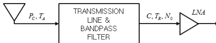
그림 2-7. 저잡음 증폭기(LNA) 배치
