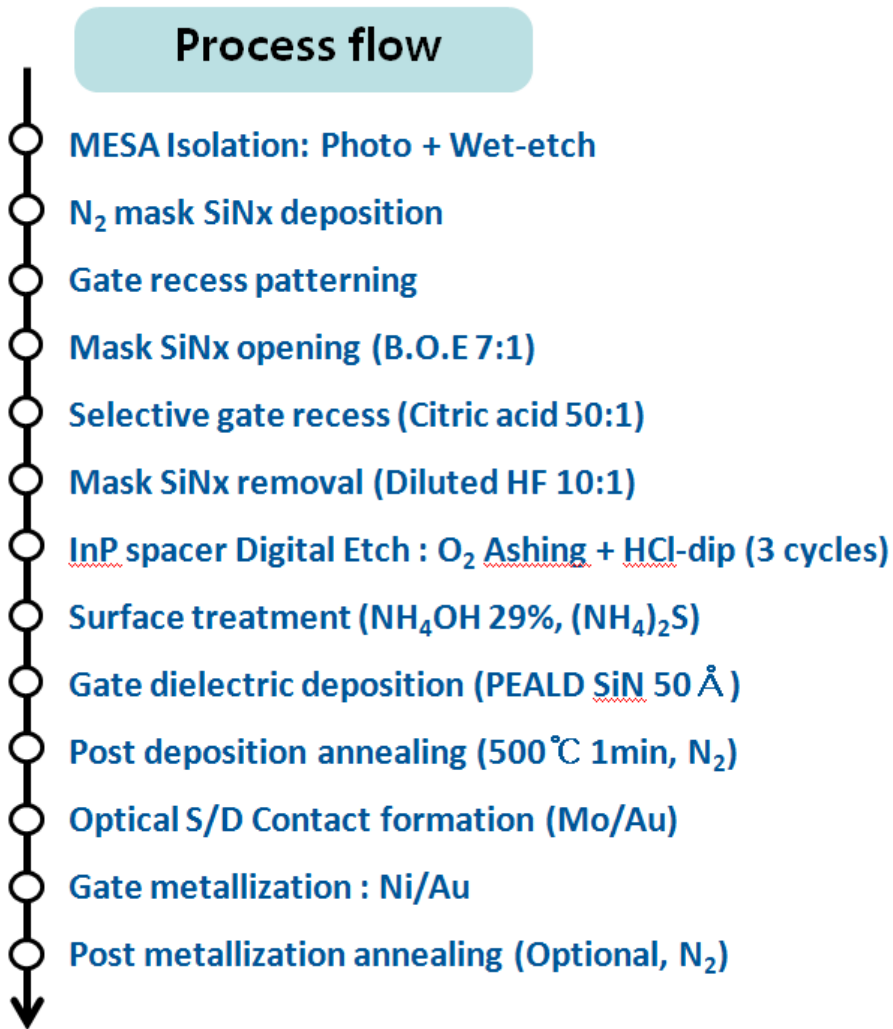
그림 4.1 Process flow of InGaAs MISFET
