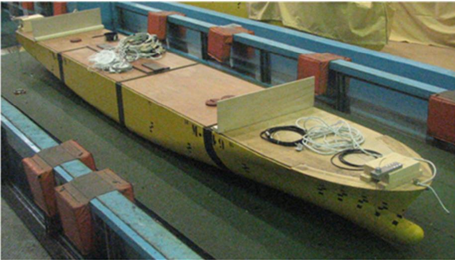
사진 3.2 쌍측 13,000 TEU 급 컨테이너 운반선의 예인수조 시험 용 모형
