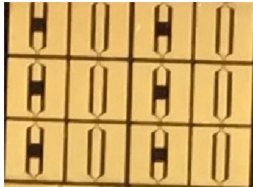
그림 5.7 실리콘 산화막이 증착된 실리콘 기판의 트렌치 유무에 따른 재배선층 특성 검증을 위한 테스트 패턴의 제작 결과
