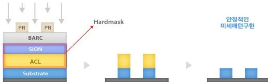
그림 4.1.1 Amorphous carbon 필름을 이용한 식각 패터닝 [35]
