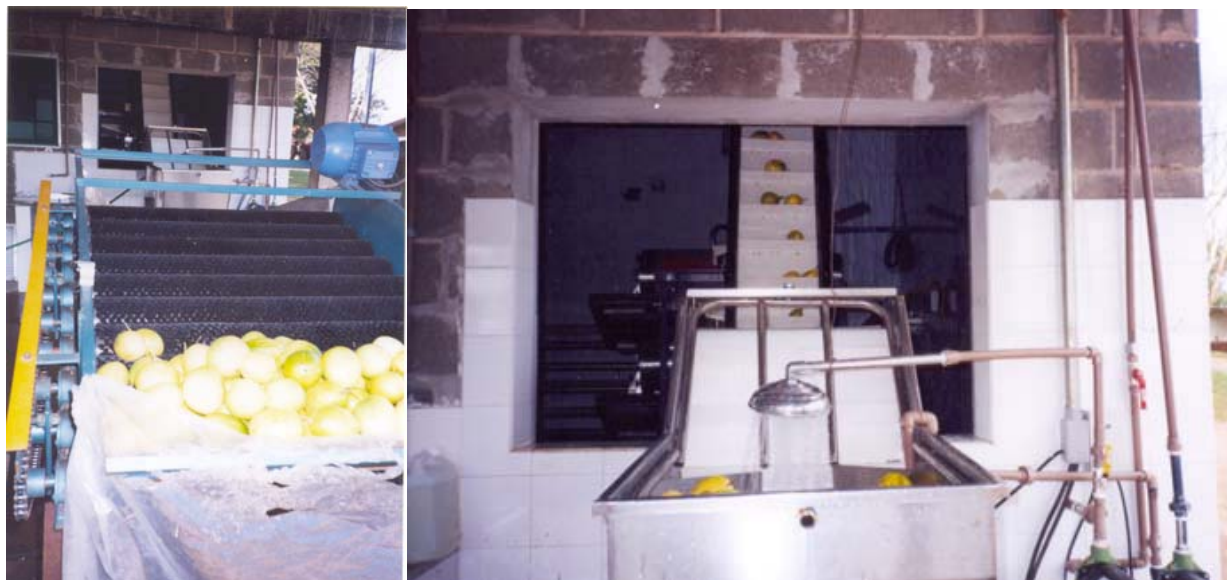
Figura 2. Escova, lavador e esteira de elevação de frutos, Bauru (SP).
