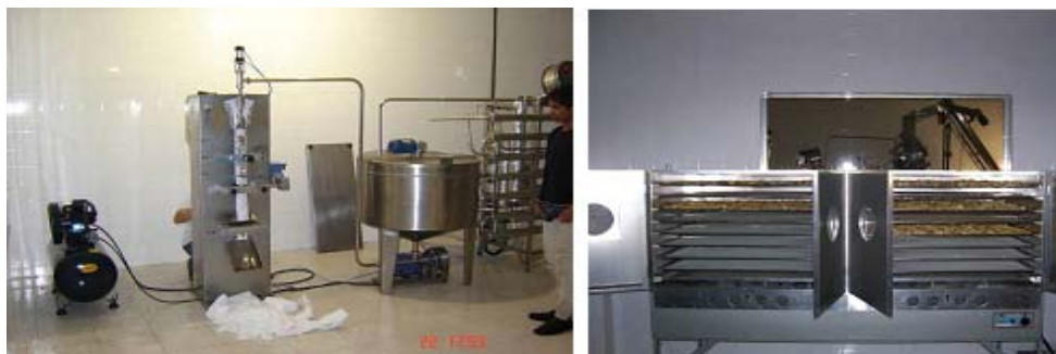
Figura 6. Vista geral da embaladeira automática de polpa e da estufa de circulação de ar forçado, Bauru (SP).
