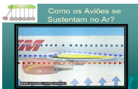
Figura 1. Representa o vídeo que demonstra a sustentação do avião no ar a partir da diferença de pressão e velocidade do ar passando as diferentes partes da asa. (Palestra: 'Física Aplicada Às Aeronaves').
