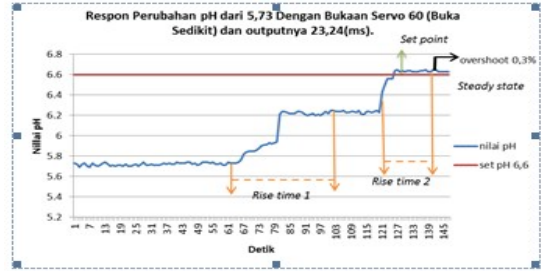
Gambar 8. Grafik Respon Perubahan pH dari 5,73 Dengan Buka Servo 60 (Buka Sedikit) dan outputnya 23,24(ms).
