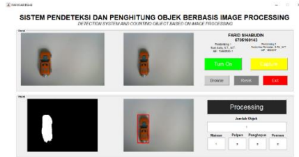
Gambar 4 8 Contoh pengujian terhadap jarak 25cm
