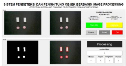
Gambar 4 1 Contoh pengujian terhadap latar hitam
