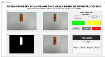
Gambar 4 9 Contoh pengujian terhadap jarak 30cm
