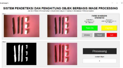
Gambar 4 3 pengujian terhadap latar merah
