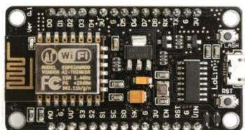
Gambar 3.1 *NodeMCU*
