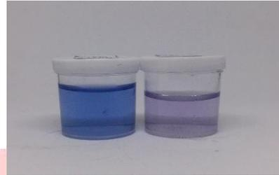
Gambar 3.10 Methylene Blue 15,625 mg/l dengan TiO<sub>2</sub>
