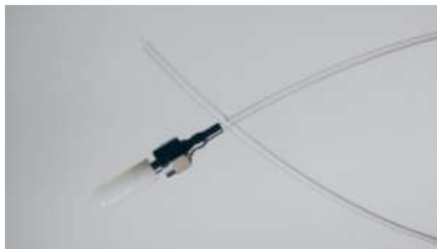
Figura 8– Fibra óptica polimérica em estudo. Fonte: elaborada pelo autor.
