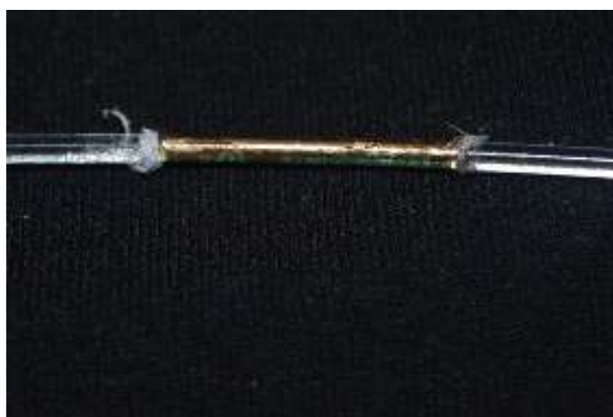
Figura 18– Fibra óptica de plástico revestida com Ouro. Fonte: [42].
