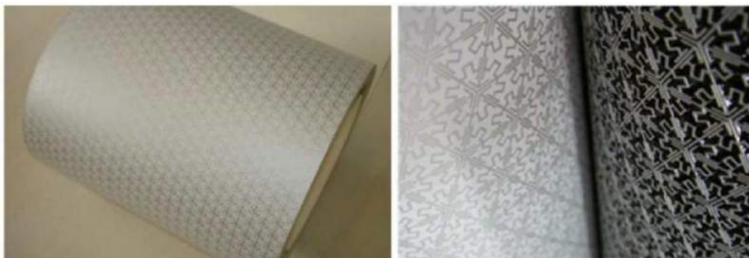
Figura 3-19 - FSS em forma de papel de parede [52].
