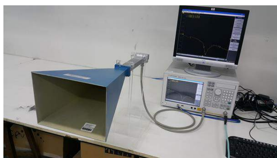
(a) Analisador de rede e antena corneta
