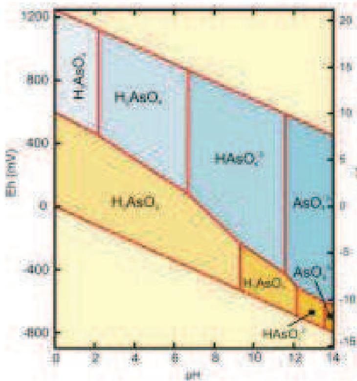
Figura 1. Diagrama Eh-pH de especies acuáticas de arsénico en el sistema As-O<sub>2</sub>-H<sub>2</sub>O [1].
