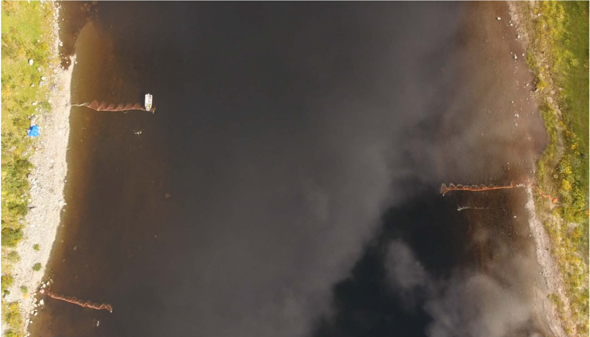
Kuva 9. Kuvassa Tenojoen pääuoman seuranta-asetelma vuodelta 2018. Vasemmalle rannalle (pohjoisranta) on sijoitettuna sekä Simsonar- että Aris-luotaimet ja oikealle rannalle (eteläranta) vain Simsonar-luotain. Kuvassa näkyvät myös luotaimien alavirranpuolelle sijoitetut ohjausaitarakenteet. Kuva: Jari Lindeman.
