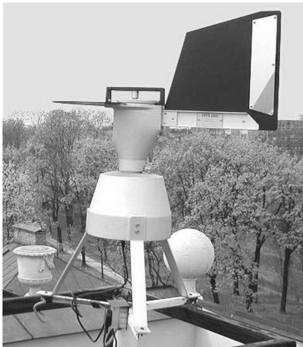
Ryc. 1. Stacjonarny aparat VPPS 2000 do analiz wolumetrycznych (Lanzoni s.r.l., Bologna, Włochy)
