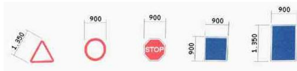
Figura 1-15: Dimensiones de las principales señales verticales
