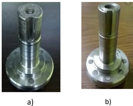
Figura 2.30. Recuperación por metalización de flecha desgastada. (Fuente: https://www.youtube.com/watch?v=kNuQG1jvNvI )
