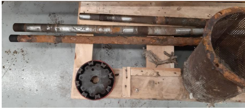
Figura 3.12. Eje de la bomba.
