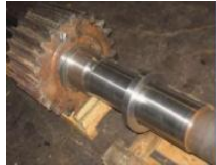
Figura 2.16. Eje recuperado por proyección térmica por llama. (Fuente: https://es.slideshare.net/deibyrequenamarcelo/01-proceso-recubrimientos-proyeccion-termica )
