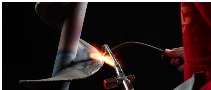
Figura 2.8. Recuperación mediante soldadura manual con llama oxiacetilénica. (Fuente: https://www.castolin.com/es-MX/nuestras-tecnologias )
