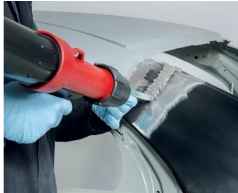
Figura 2.48. Regeneración de partes perdidas mediante loctite. (Fuente: https://www.motorok.com/noticias/soldadura-en-frio-loctite/ )
