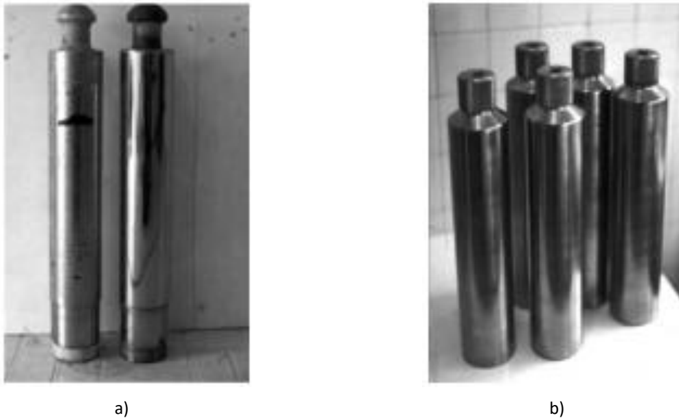
Figura 2.22. Reconstrucción de émbolos de bomba hidráulica de la industria petrolera por proyección térmica con aleaciones auto fundentes Ni – Cr – B – C. (Fuente:
