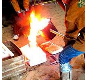
Figura 2.58. Proceso de fundición biometálica en moldes con recubrimientos antioxidantes.
