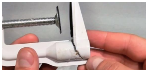
Figura 2.47. Reparación con pegamento para aluminio.
