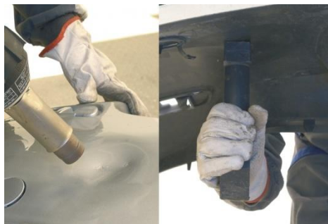
Figura 2.45. Recuperación de abolladura por deformación térmica.
