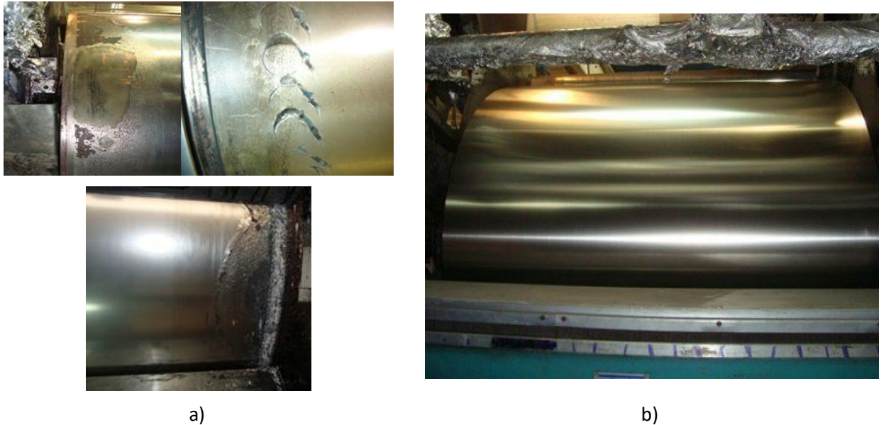
Figura 2.25. Recuperación por metalización de tambor central. (Fuente: https://flextec.com.co/project/metalizacion-de-tambor/ )
