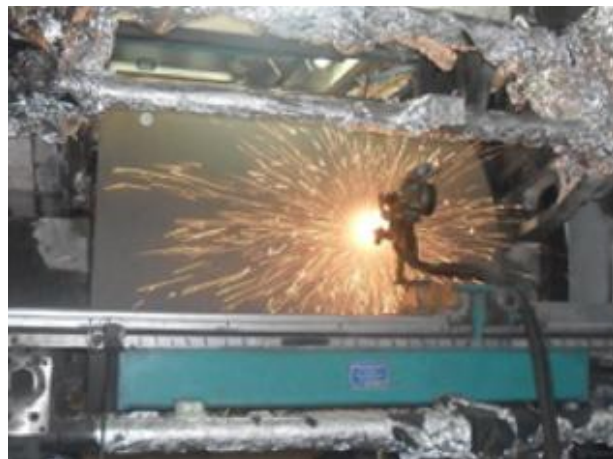
Figura 2.24. Proyección de partículas en la recuperación por metalización. (Fuente: https://flextec.com.co/project/metalizacion-de-tambor/ )
