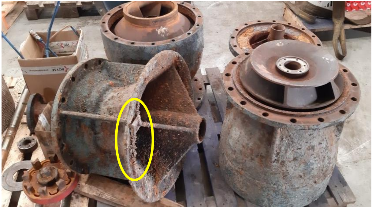
Figura 3.8. Cuerpos de los impulsores. Detalle del mejillón cebra.
