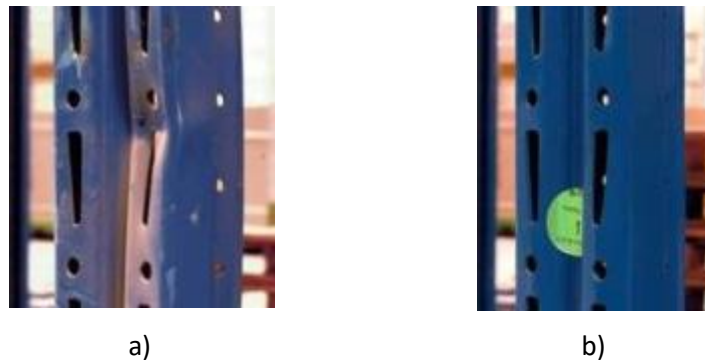
Figura 2.37. Recuperación por deformación plástica de puntales. (Figura: http://www.cadenadesuministro.es/noticias/ros-spain-certifica-su-sistema-de-reparacion-de-estanterias/ )
