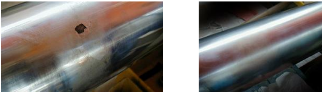
Figura 2.34. Reparación mediante brushplating. (Fuente: http://www.titansisak.hr/En_BrushPlating.html )
