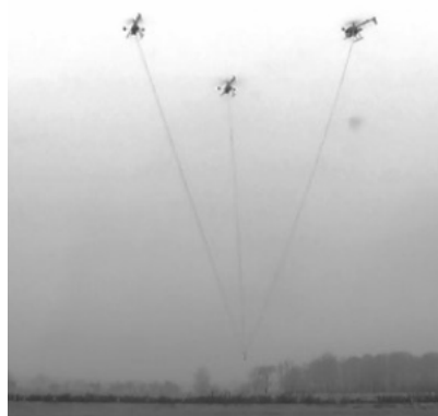
Figura 7. Transporte conjunto de carga mediante 3 helicópteros
