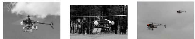
Figura 3. Helicópteros autónomos utilizados en los proyectos COMETS y AWARE. A la izquierda el prototipo Marvin I. En el centro, el Marvin II. A la derecha un experimento coordinado realizado en AWARE.
