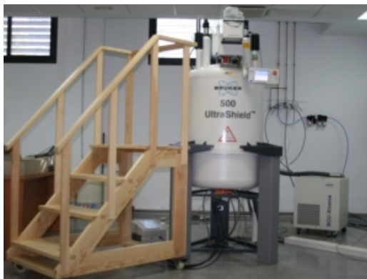
Figura 2.9. Espectrómetro Bruker Avance III 500 MHz del servicio de RMN de los Servicios Generales de Investigación de la Universidad de Sevilla (CITIUS).
