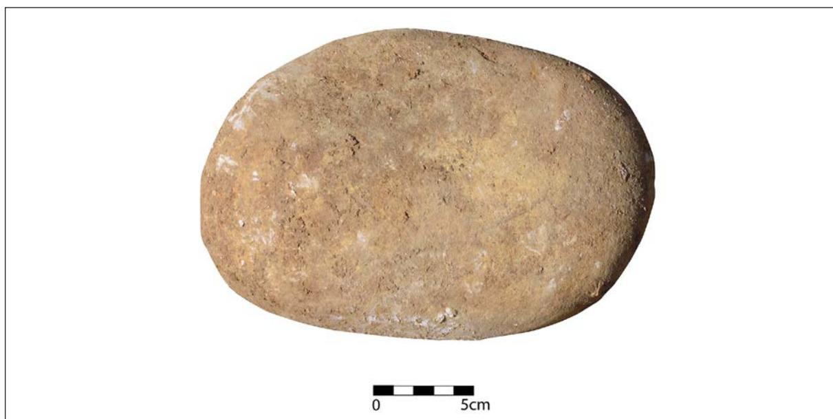
Figura 7. Exemplo do tipo de seixo utilizado na construção da alvenaria da cisterna.
