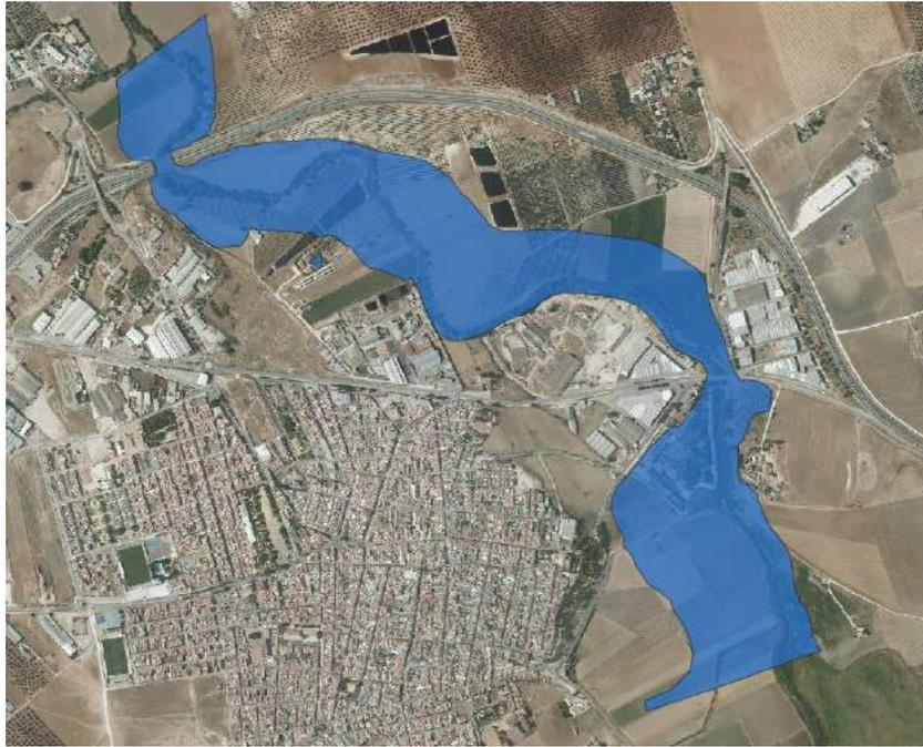
Figura 5-24. Vía de Intenso Desagüe.
