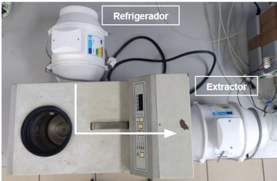
66. Disposición de los ventiladores de apoyo al BioCool.
