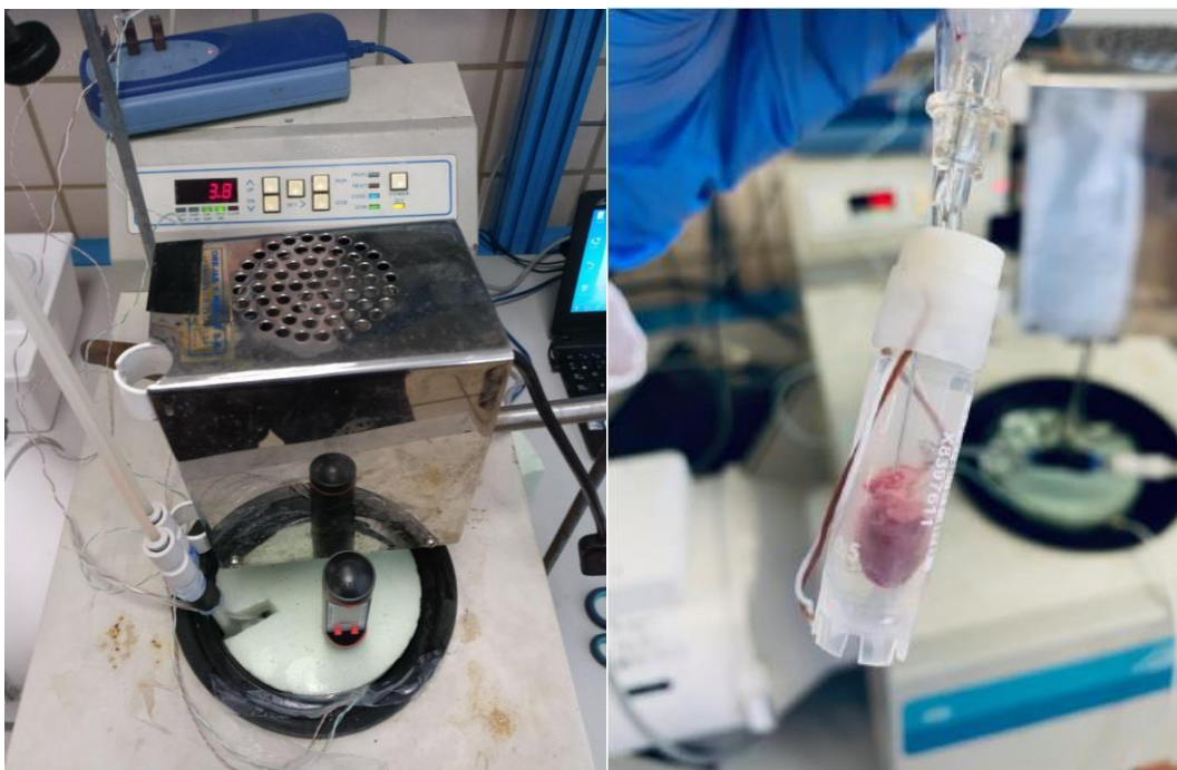
59. Izquierda: Equipo de criopreservación listo para el funcionamiento. Derecha: criovial preparado para la vitrificación.
