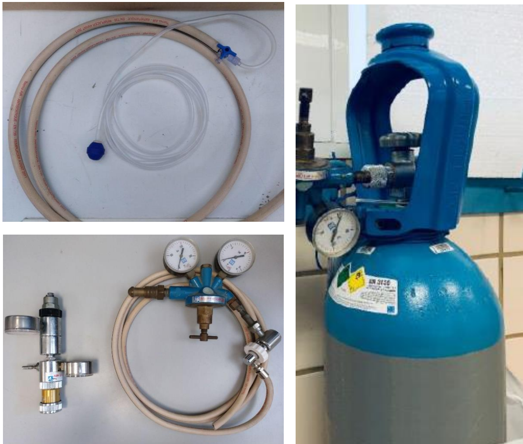
11. Superior izquierda: entubado de oxigenación. Inferior izquierda: manorreductor antiguo (izq.) y nuevo (dch.). Derecha: bombona de carbógeno.
