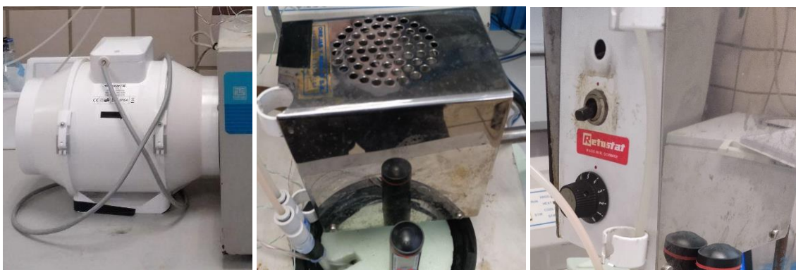
42. Modificaciones al BioCool. Izquierda: ventilador. Centro y derecha: agitador externo.
