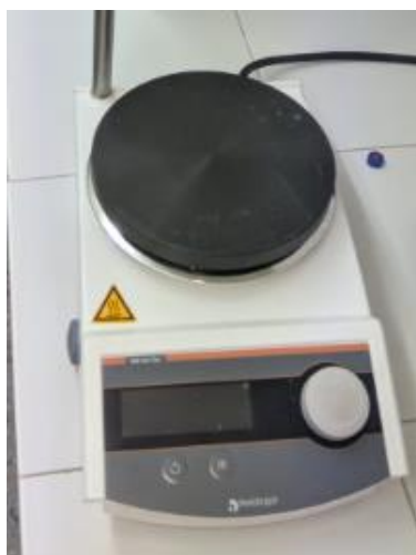
Figura 7. Agitador con control de temperatura con termopark.
