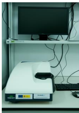
Figura 18. Analizador de Potencial Z (Zetasizer Nano ZS).
