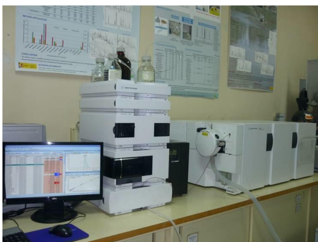
Figura 15. LC-QqQ-MS de HPLC.
