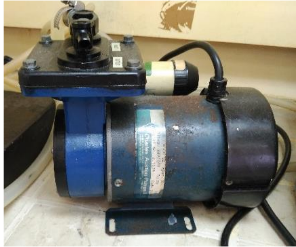
Figura 10. Bomba de vacío Charles Austen Pumps LDT modelo B100 SE.
