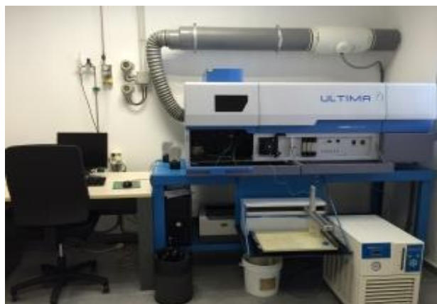
Figura 17. Espectrómetro de Emisión Atómica por Plasma ICP.
