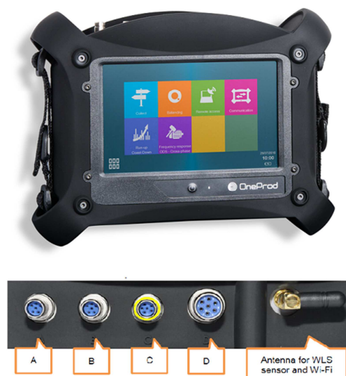
Figura 3.5. Equipo analizador de vibraciones FALCON
