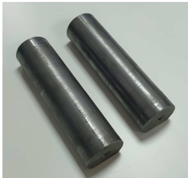
Figura 3.9. Soportes para apoyar la viga
