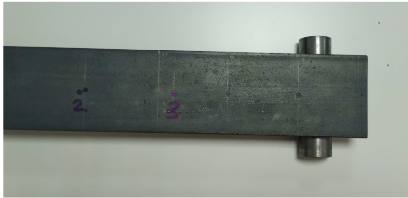
Figura 3.8. Extremo de la viga en el que se muestra uno de los soportes
