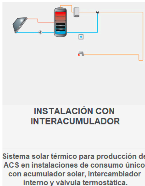
Figura 28. Configuración de la instalación.
