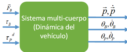
Figura 2.3: Fuerza y par propulsivo
