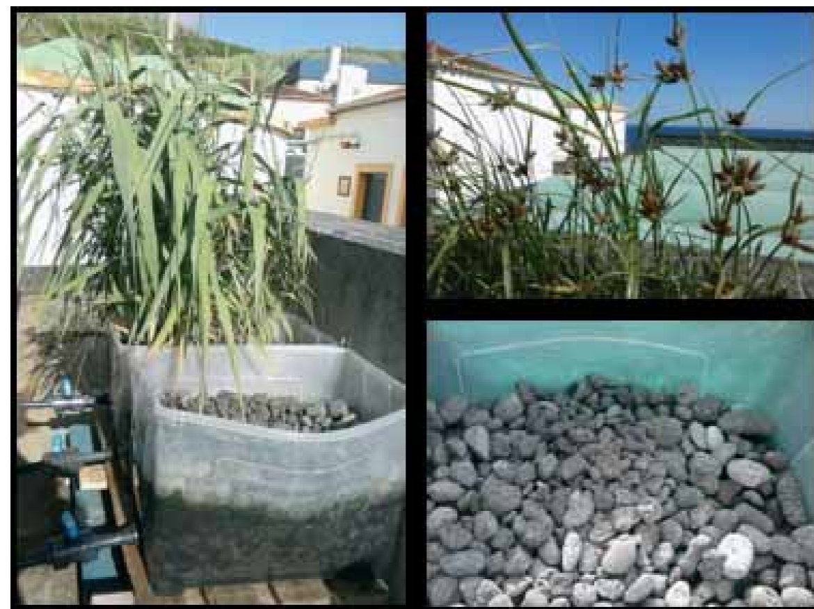
Figura 1 – Ensaio piloto de Zona Húmida Construída para tratamento complementar de água residual
