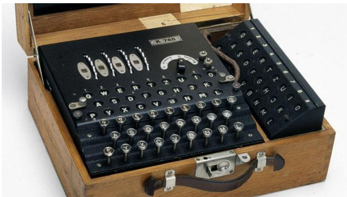
Slika 5. Enigma, njemački stroj za šifriranje i dešifriranje poruka u Drugom svjetskom ratu 19
