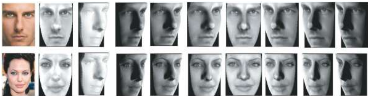
Slika 18. Primjer izrade 3D modela iz slika s interneta (prva slika iz svakog reda, ostale su generirani modeli za različite poze)
