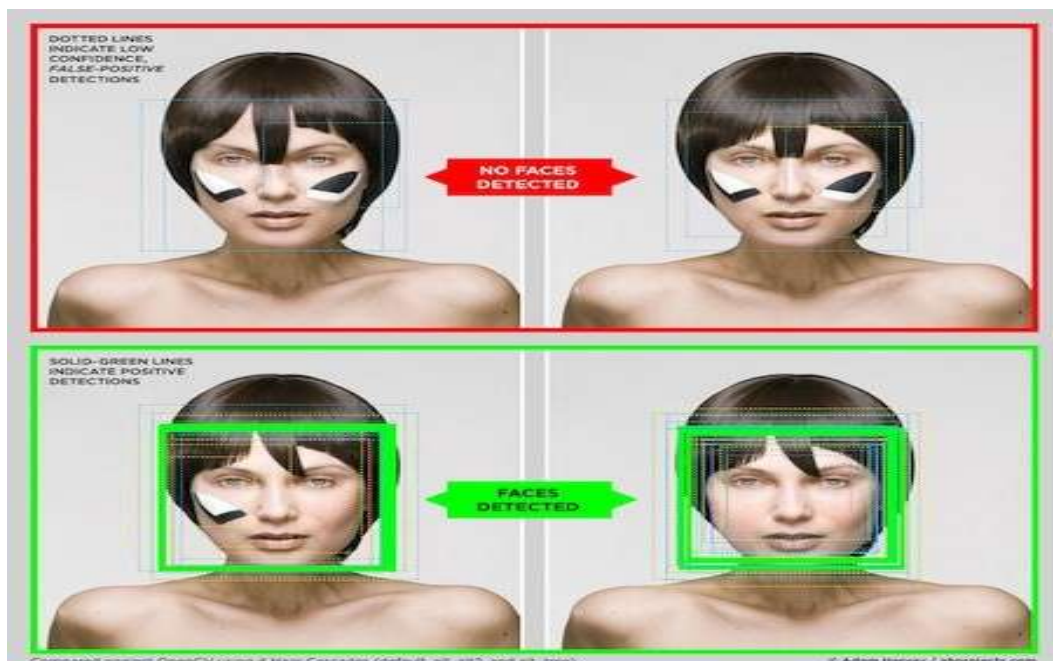
Slika 2. Primjer nenalaženja lica zbog krivog kontrasta između nosa i čela zbog šminke i kose (gornji red), te pozitivni nalaz lica zbog točnih kontrasta, prema [14]
