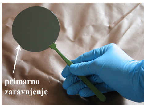
Slika 2.3 – Primarno zaravnjenje na silicijumskoj pločici [9] .
