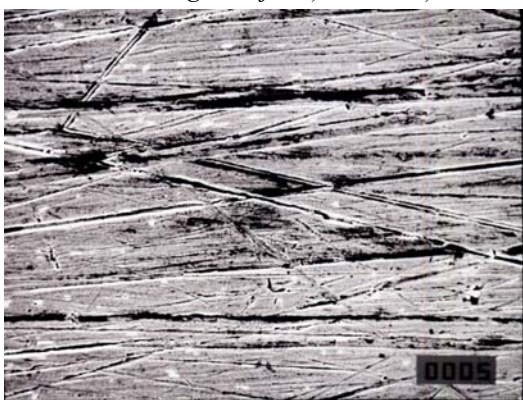
Slika 6 - SEM fotografija mehanički glačanog uzorka Cu. X750
