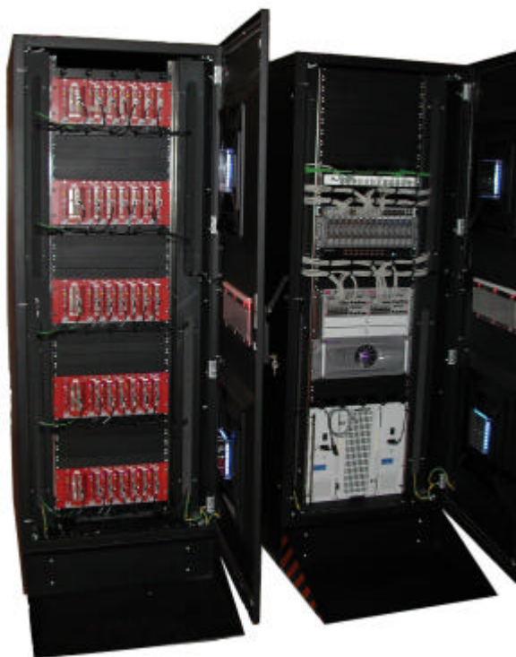
Fig. 3 – Dettaglio di uno degli armadi di calcolo e dell'armadio di servizio di michelangelo.
