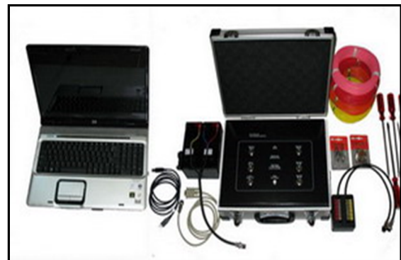
Gambar 3 Alat geolistrik tahanan jenis S-Field
