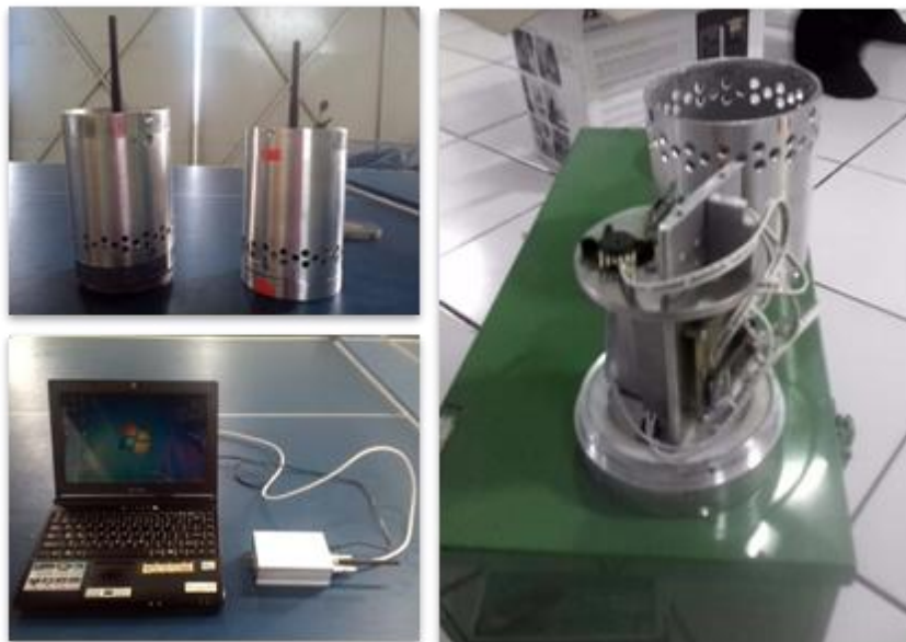
Gambar 3-1: Muatan pengukur atmosfer (kiri atas) dan bagian dalamnya (kanan). Sistem penerima data yang terhubung ke laptop (kiri bawah)
