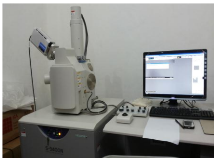
Gambar 5. SEM untuk pengamatan struktur mikro, M hingga 5000x
